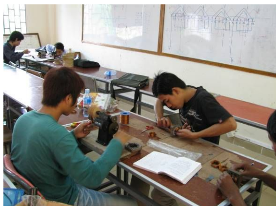
モーターのコイルを取り換える作業。ここまでやるかと感心するが、壊れた扇風機も再生します。
