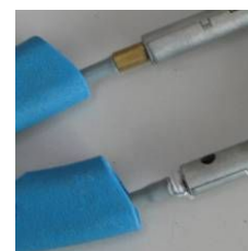
左:裁縫道具。右:上は良品。下はケーブルの不良箇所を切断し端を糸で固定したもの。
